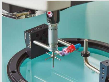
Messung eines in medizinischen Geräten eingesetzten Ventils
