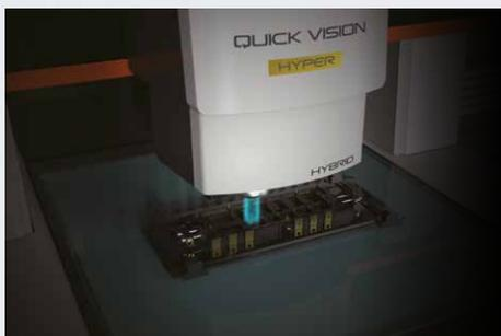
Messung einer Motorsteuerung
