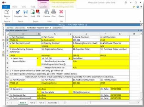
Die Erstmusterprüfansicht in Real-Time oder Process Analyzer bietet einen klaren und präzisen Ansatz für die Erstellung von Erstmusterprüfberichten nach AS9102. Die Funktion umfasst die Formulare 1, 2 und 3 mit Optionen für den Export in Excel oder PDF und ermöglicht Benutzern die Suche nach Erstmusterprüf- und Produktionsdaten an einem zentralen Ort.
