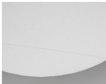
verkratzte hochglanzpolierte Fläche
