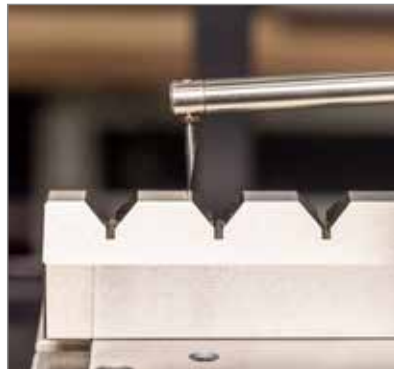
Längenmessabweichung der X-Achse eines Konturmessgeräts
