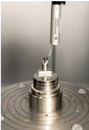
Überprüfung des Tastsystems
